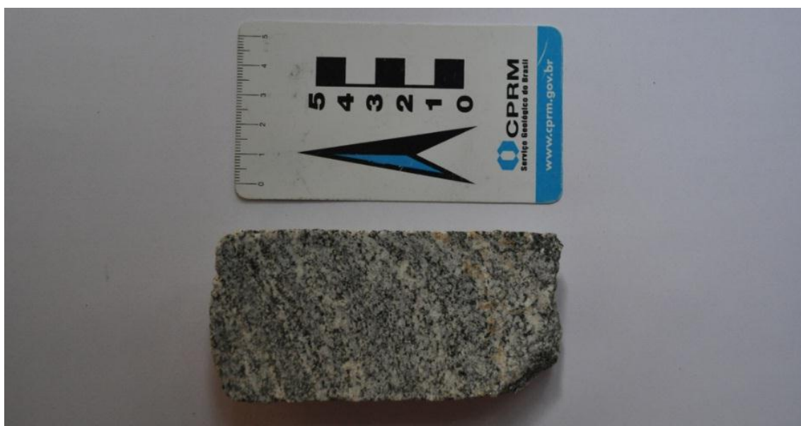
Figura 9 - Amostra 5177 A – biotita gnaiss. Amostra representativa do litotipo; claro bandamento alternando leitos quartzo-feldspáticos e biotíticos.
