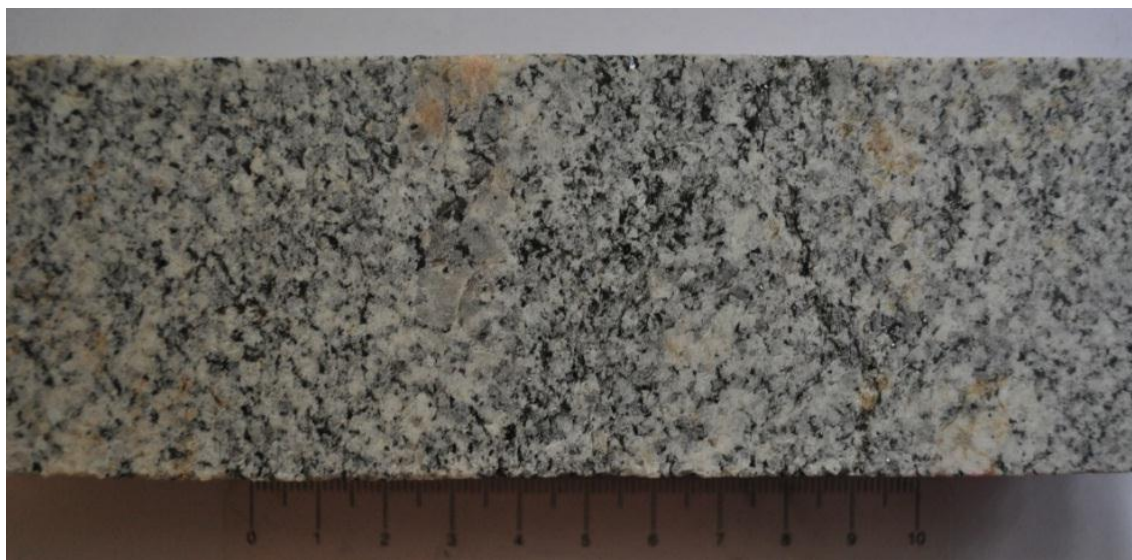
Figura 19 - Amostra 5211 A – diatextito. Notar o bandamento incipiente, alternando porções de granulação média a grossa com pouca biotita, e leitos de granulação média com maior proporção de biotita em relação à anterior.
